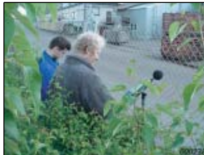
Fig. 4 Evaluation d'une émergence tonale dans le bruit généré aux alentours d'une usine
